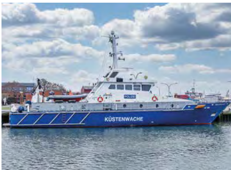
Blick auf Steuerhaus und Achterschiff mit Tochterboot. Der schnelle Flitzer ist blitzschnell ausgesetzt, sehr wendig und kann auch Schiffbrüchige aufnehmen.
